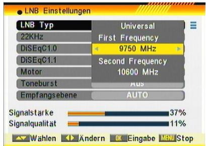
Sie können die vorgegebenen Werte für die Umsetzungsfrequenz (Oszillator) aber auch ändern. Welche Frequenzen Ihr LNB verwendet, erfahren Sie über das Typenschild des LNB.
